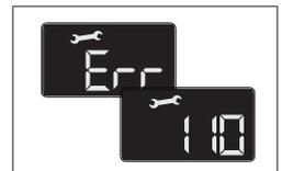
**Защитное отключение из-за низкого давления воды**
